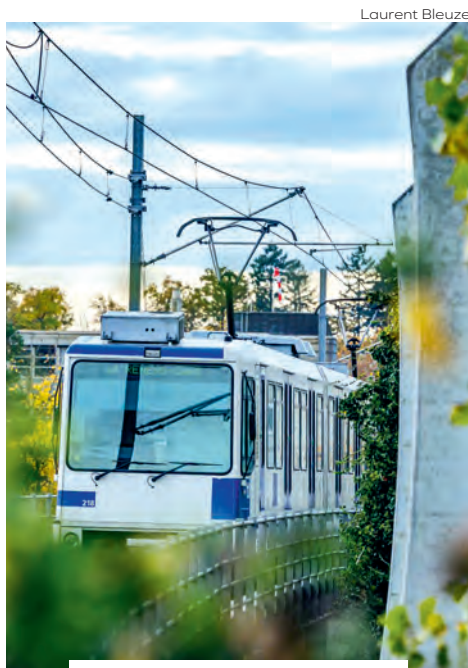
L'électricité propulse le métro m1 au moyen de la ligne aérienne de contact.
